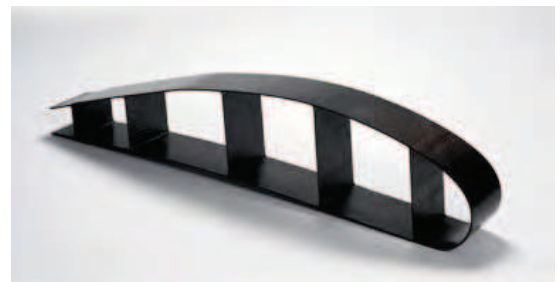
Leichtbau spart Material und Energie: Abschnitt einer Flugzeuglandeklappe aus kohlefaserverstärktem Kunststoff (CFK).
